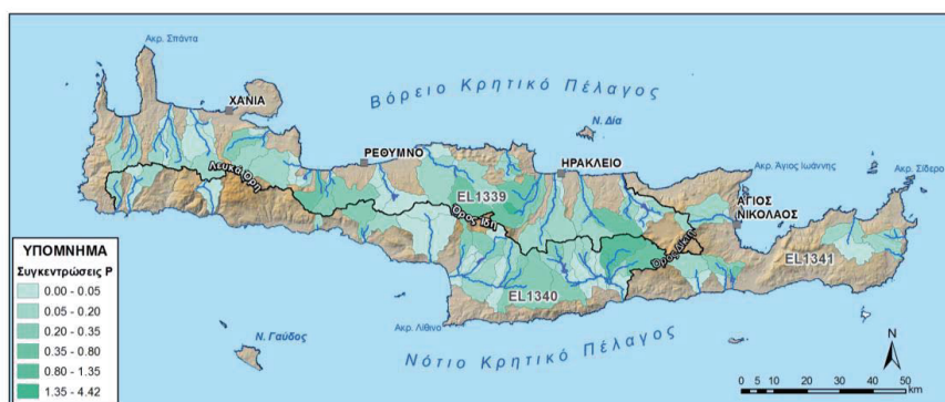
Χάρτης 5-9 Ετήσια διάλυση P (mg/l) από το σύνολο των πηγών ρύπανσης στο ΥΔ Κρήτης (ΕΛ13)
